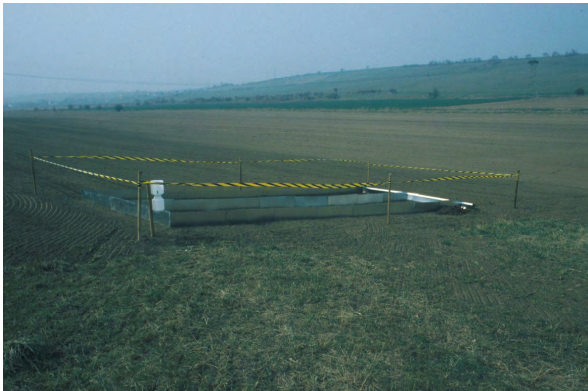
Abb. 4.5: Erosionsmessfeld bei Erdeborn mit Versuchsaufbau zur Abtragsmessung (Foto: G. Schmidt)
